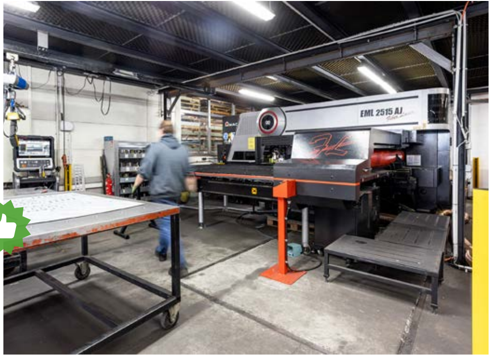
Arbeitet schneller, präziser, sparsamer: die neue Stanz-Laser- Kombinationsmaschine
